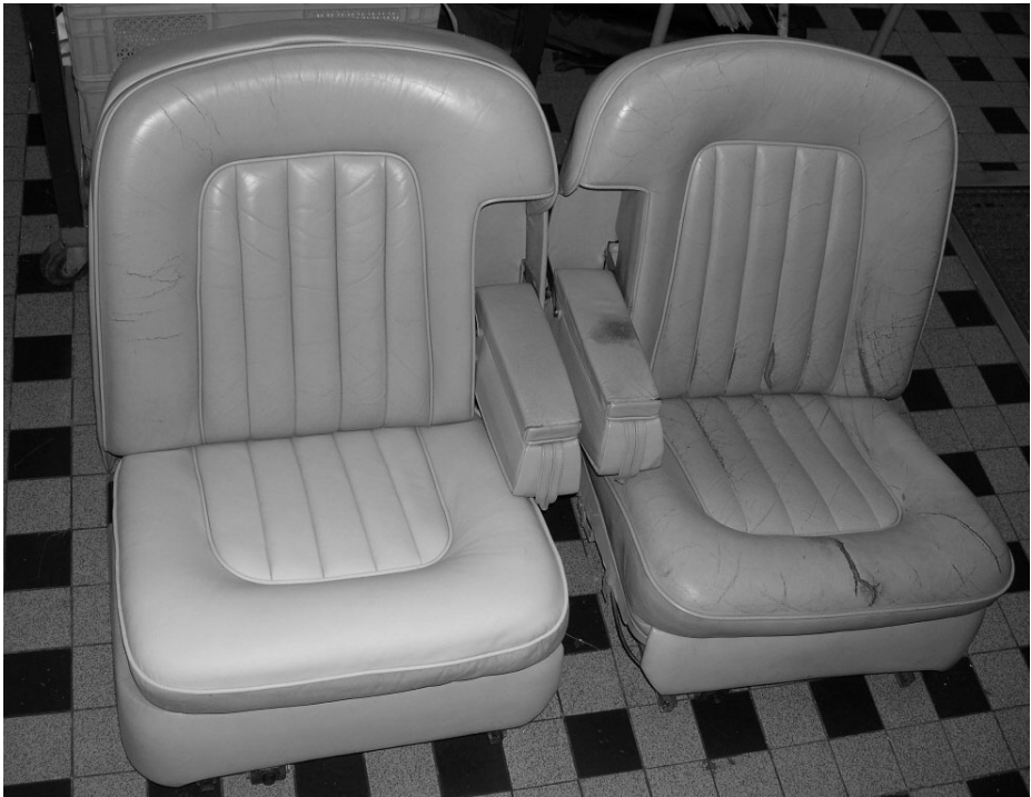
De zitting is vervangen; het verschil is overduidelijk.
