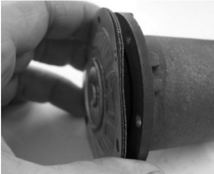
Figuur 6. Het losdraaien van het membraan.
