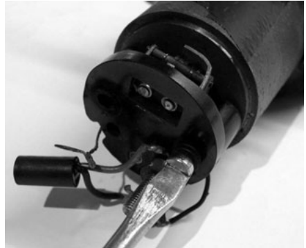
Figuur 9. Demontage van de diode en de houder.
