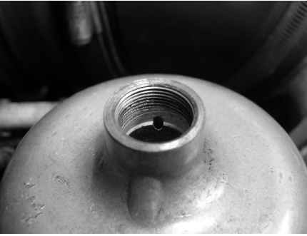
Figuur 24. Het punt waar de luchtstroom te beluisteren valt.
