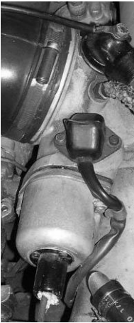
Figuur 9. Het chokehuis zit tussen de carburateurs gemonteerd.
