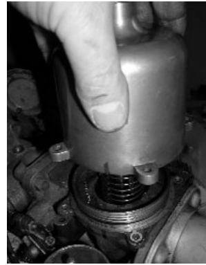
Figuur 14. Verwijder de vacuüm klok.
