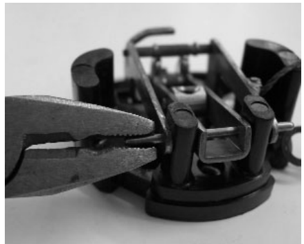
Figuur 10. Demontage van de scharnieren.
