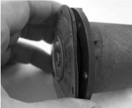
Figuur 6. Het losdraaien van het membraan.
