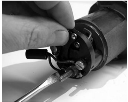
Figuur 8. Demontage van de bovenste contactpuntjes.
